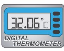
**نمونه** در دماسنجدیجیتال شکل مقابل، که عدد  $32.06^\circ\text{C}$  را می‌خواند، دقت دماسنجدیجیتال  $1^\circ\text{C}$  و خطای  $0.06^\circ\text{C}$  آن برابر  $1^\circ\text{C}$  است.
